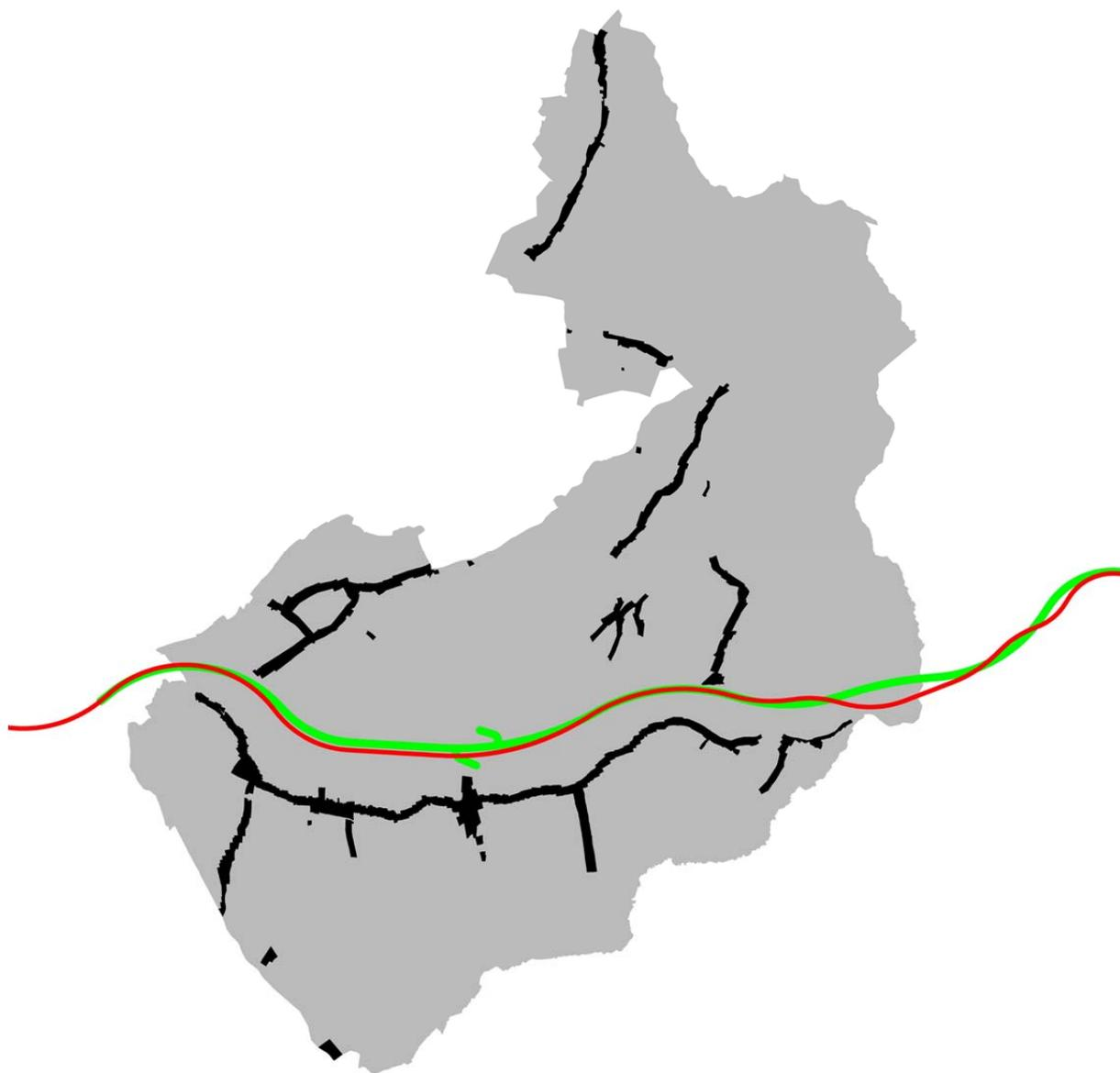
Trasa iz važećeg PPUO prikazana je crvenom linijom, nova trasa zelenom linijom. Nova trasa unesena je Plan te je za nju planom rezerviran koridor širine 150 m.
